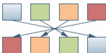
Figur 44: Omstokking av byte fra Big Endian til Little Endian
